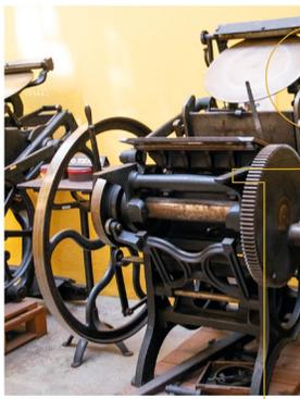
Se caracteriza por ser un sistema de impresión directo debido a que el molde o la plancha transfieren de manera directa la imagen sobre el soporte.
