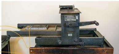
Presna para pruebas montada con pedestal de hierro, con anaquel para guardar y preservar del polvo los rodillos entintadores y los botes de tinta.
