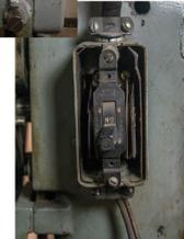
Interruptor de apagado y encendido.
