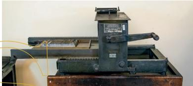
Prensa para pruebas montada con pedestal de hierro, con anaquel para guardar y preservar del polvo los rodillos entintadores y los botes de tinta.
