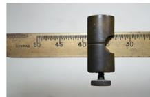
Detalle de cómo se sujeta la pesa de medición.
