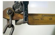
Detalle del sistema de unión de la pesa con la barra de medición.
