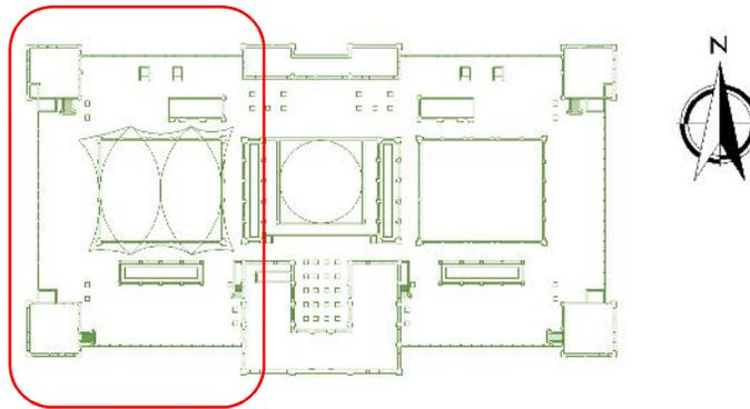
En este espacio es de uso común para la conexión de las distintas áreas en azotea, en la actualidad consta de una membrana con distintas formas orgánicas simétricas por encima de una estructura compuesta de metal con distintos diámetros que descansa en las basamentas ancladas al piso de la misma losa, con el fin de proteger el patio de la paz del intemperismo.
