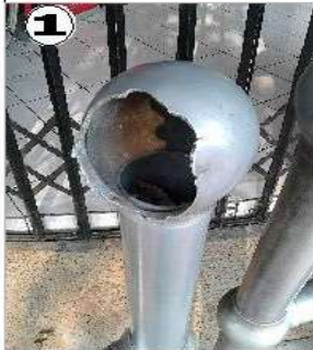
Foto 1. Los daños pudieron dar por fatiga de materiales y por vandalismo, según los guardias del Teatro de Bellas Artes, este tubo fue arrancado.
