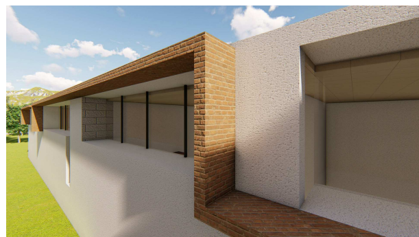
FACHALETA DE LADRILLO EN PARTELUCE.
