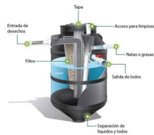
Sistemas de biodigestores para el tratamiento de aguas negras por medio de contenedores cerrados, herméticos e impermeables para no afectar los cuerpos de agua del terreno, y devolver el recurso del agua a la tierra después de un proceso de filtración por medio de pozos de absorción
