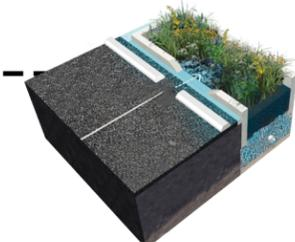
Sistema de recolección de agua en el parqueo a través de concreto permeable, aprovechando la pendiente del estacionamiento dirigida hacia la vegetación perimetral para usos de riego de las mismas.
