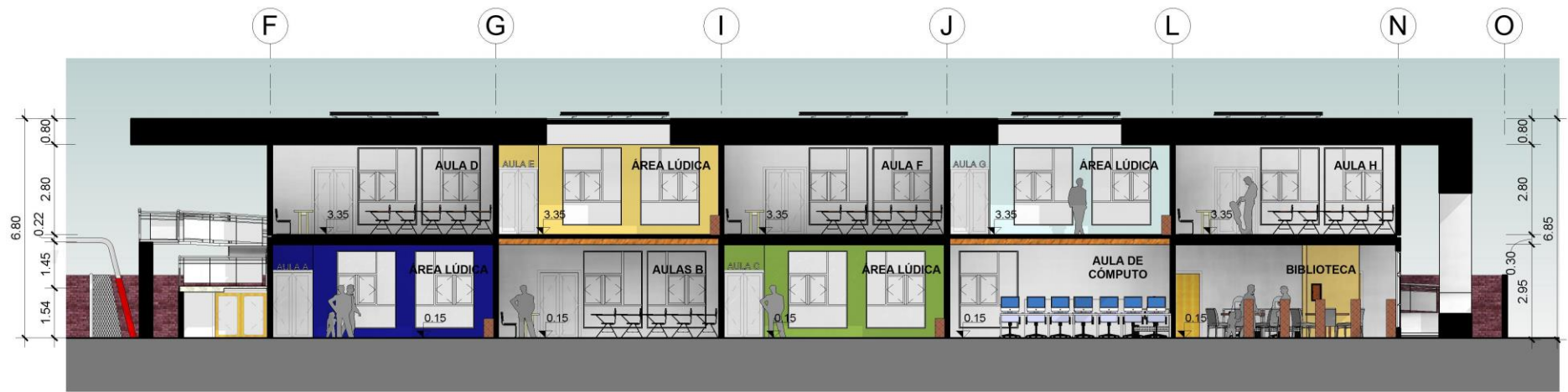
1 Aulas Escolares - Sección A-A' Esc.1 : 125
