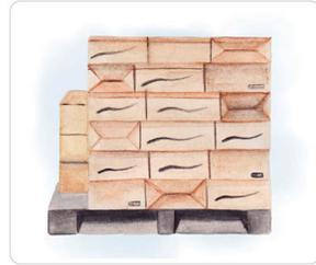
La altura mínima entre el suelo y el producto debe de ser no menos de 20 cm y la altura máxima entre el techo y la estiba debe de ser de 0.60m a 0.9m entre sí para permitir la circulación de aire en el cuarto frío el cual debe de encontrarse máximo a 4°C equivalente a 43°F y los almacenados en el estero del cuarto frío, no deben de superar la temperatura ambiente, que según la Unión Internacional de Búrnico Frío y Aplicado (UIFC) es de 35°C equivalente a 77°F.
