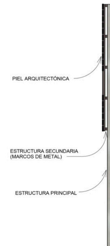
LATERAL PIEL ARQUITECTÓNICA
