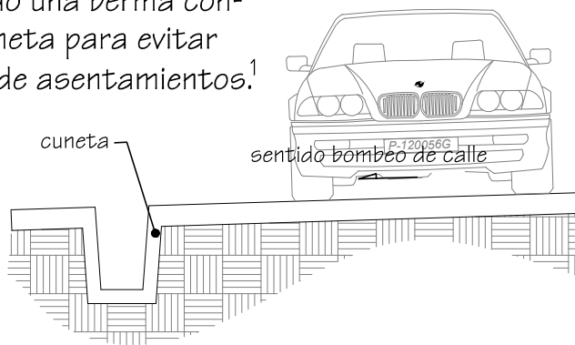
Sección típica Cuneta en carreteras Esc. 1/50
