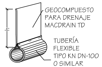
Detalle geocompuesto y tubería flexible Ø 4" Escala 1/25
