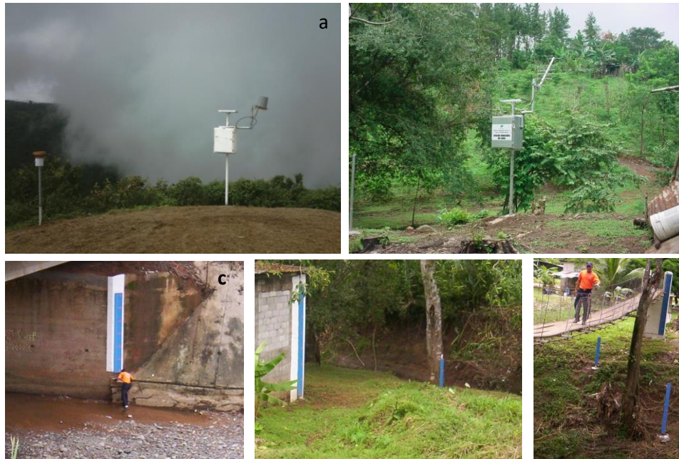
Figura 56 Fotografías detalladas del equipo y la experiencia de ese SAT analizado. a) Estación meteorológica satelital en Cerro Pelón, b) Estación hidrológica satelital en Rancho Café. Fotografías parte inferior; Reglas limnimétricas para monitoreo de altura del rio, c) Puente Rancho Café, d) Puente Panamericana, e) Puente Zarzo (ETESA, n.d.).
