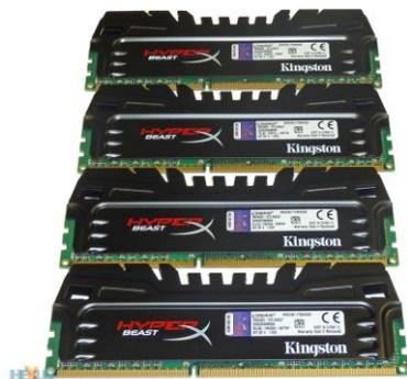
Las memorias RAM vienen de un tamaño rectangular y se acoplan a la CPU<sup>11</sup>
