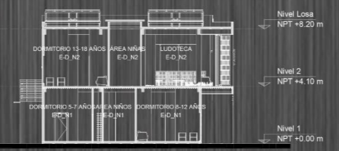
S4 E-D TRASVERSAL_2 ESC. 1 : 200 Sección de edificio
