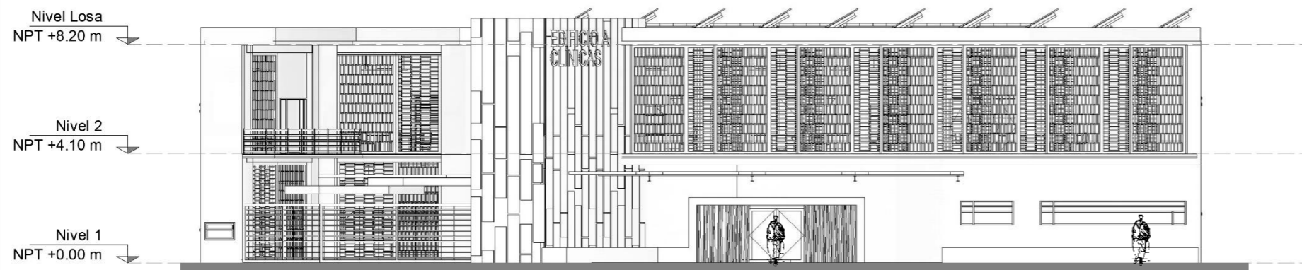
F-S Fachada Frontal ESC. 1 : 200 Alzado de edificio
