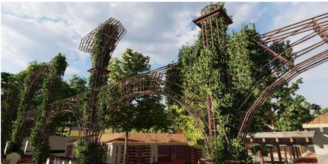
-Figura 140- Estructura Metálica cubierta por Enredaderas como Sistema Pasivo de Climatización
