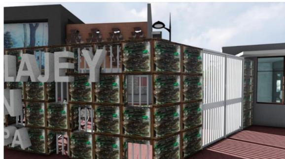
MURO DE LA FACHADA ELABORADO CON BOTELLAS DE PLÁSTICO PENSADOS RELLENANDO CAJAS CON ARISTAS DE MADERA.
