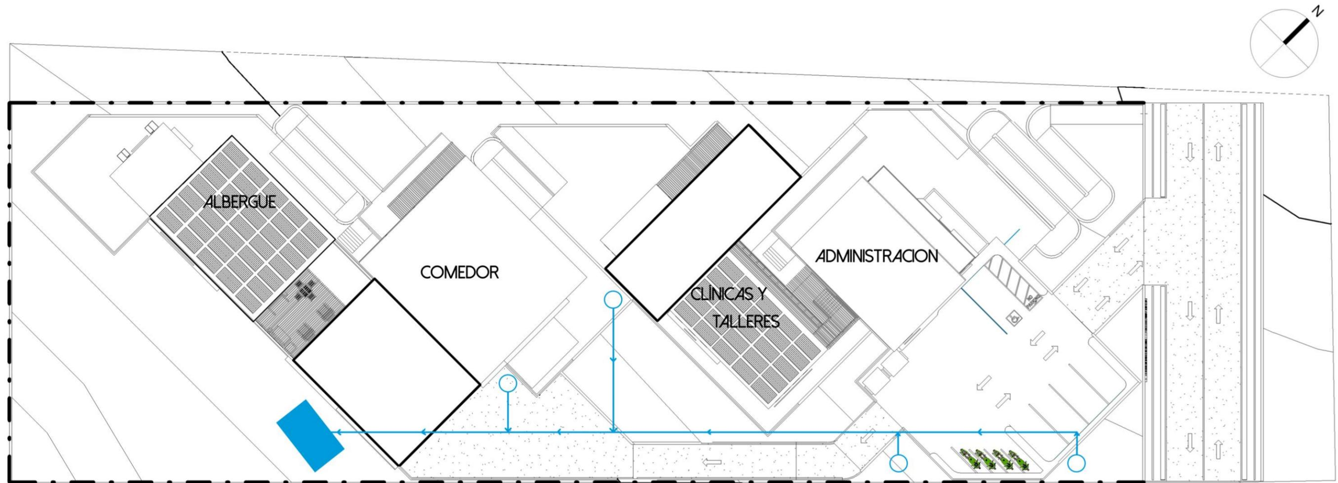
**ESQUEMA DE SISTEMA DE DISTRIBUCIÓN DE AGUA POTABLE**
