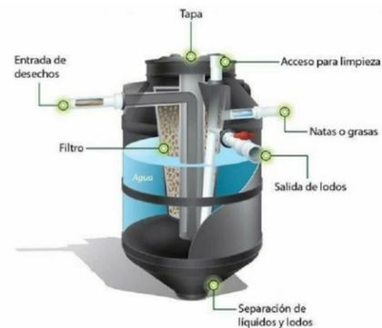
Se utilizarán biodigestores para el tratamiento de aguas negras y grises de todo el conjunto para su descarga posterior a un campo de infiltración, pozo o drenaje. Para el proyecto se utilizarán pozos de absorción y campos de infiltración, según el caso conveniente.
