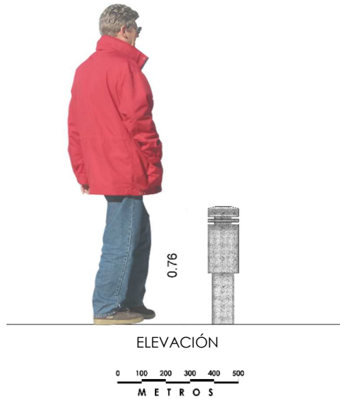
Figura No. 192. Mobiliario urbano para protección peatonal. Fuente: elaboración propia, 2020
