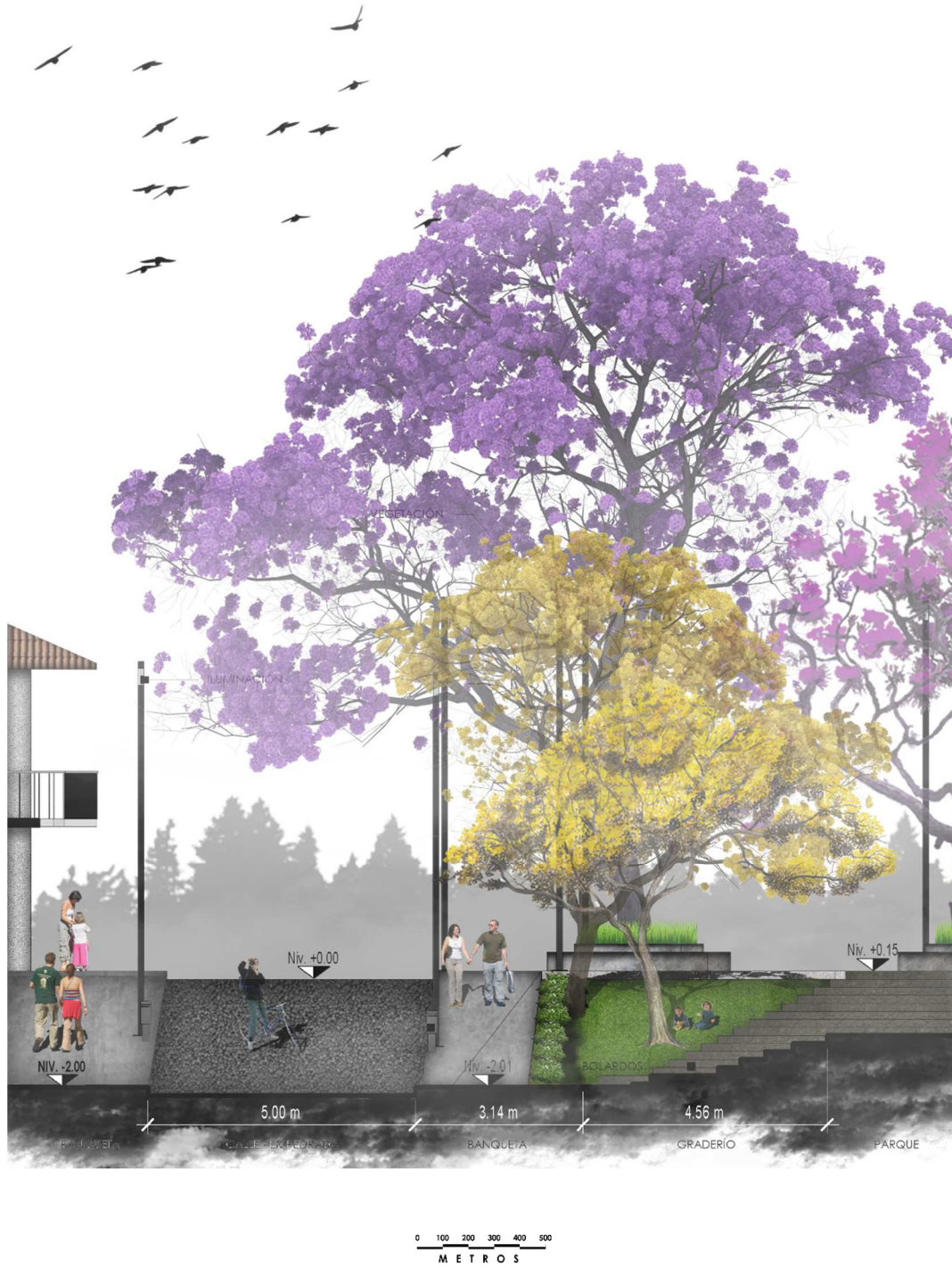
Figura No. 181. Gabarito de 7ª calle frente al parque central. Fuente: elaboración propia, 2020
