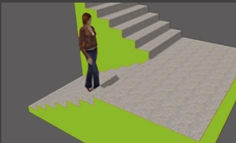
**Gradas:** Las escaleras contarán con un máximo de 15 peldaños entre descanso. El ancho mínimo de la huella es 25 cms, la contrahuella de los escalones tendrá un máximo de 18 cms y un mínimo de 10 cms.
