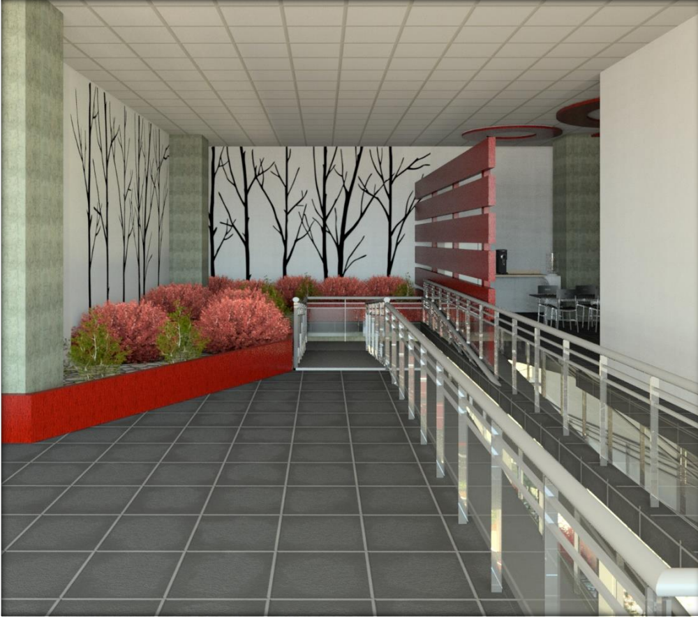
Figura 94: CIRCULACIÓN VERTICAL: el edificio I posee dos módulos de circulación vertical uno de gradas y otro de rampa. En la imagen se observa el módulo de rampa, este da directo a un pasillo el cual se encuentra ambientado con un jardín interno el cual poseerá plantas de sombra, las cuales serán coloridas y de pequeña estatura, como begonias, azaleas, violetas, etc.
