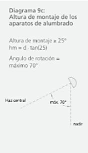
Imagen # 29. Altura de montaje de los aparatos de alumbrado. Fuente: Estadios de Fútbol. FIFA, 2019
