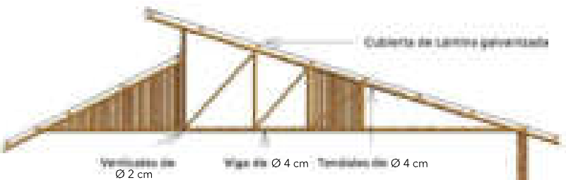
DETALLE DE TIGERAS Esc. 1:50
