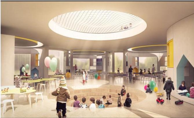
A pesar de que la manera en que los espacios se organizan no permite que entre suficiente luz y ventilación de los laterales del edificio, se crearon tragaluces que permiten ventilar e iluminar naturalmente los espacios centrales. Existen vanos en algunos muros que funcionan como áreas de estar o almacenamiento para los estudiantes y docentes, esto aumenta la eficacia del edificio sin robar espacio en los ambientes.
