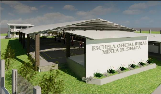
La última fase del remozamiento se encuentra aun en proceso de construcción, sin embargo, ya está todo planificado. La cancha polideportiva será cubierta con una estructura metálica con columnas y cimentación de concreto, además de la cubierta se construirá un escenario que está destinado a las actividades extracurriculares que en la escuela se llevan a cabo.
