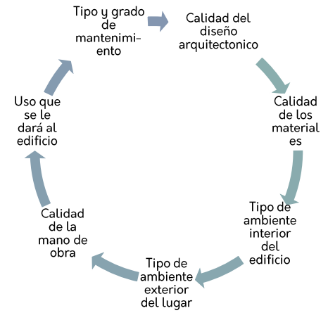
Figura 3 Criterios para estimar ciclo de vida Fuente: Elaboración propia con base en International Standards Organization, ISO 15686-1:2000, Building and constructed assets-service life planning, part 1: General principles.
