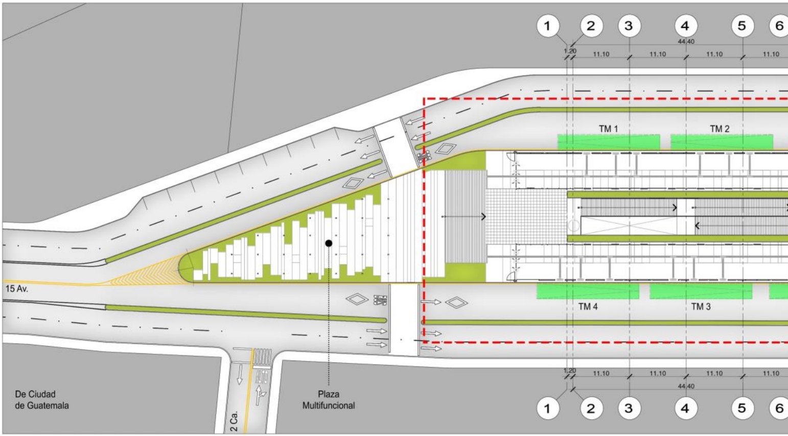
PLANTA NIVEL 1 / ANDÉN DE ABORDAJE Y DES-ABORDAJE
