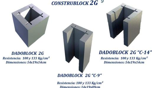
Los dadoblock son elementos que son utilizados para definir mochetas de puertas y ventanas, estos cumplen la función de obra falsa, por lo que los mismos se ofrecen en diferentes medidas, ya que en el diseño de la estructura puede ser necesario modular los diferentes vanos, según el diseño estructural que requieran las viviendas.
