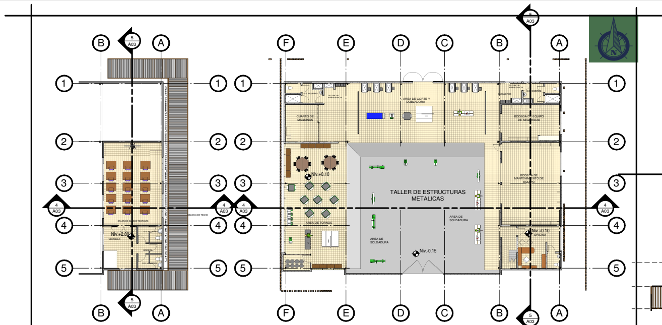
2 1-segundo Nivel de Taller de Estructuras Metalicas 1 : 200
