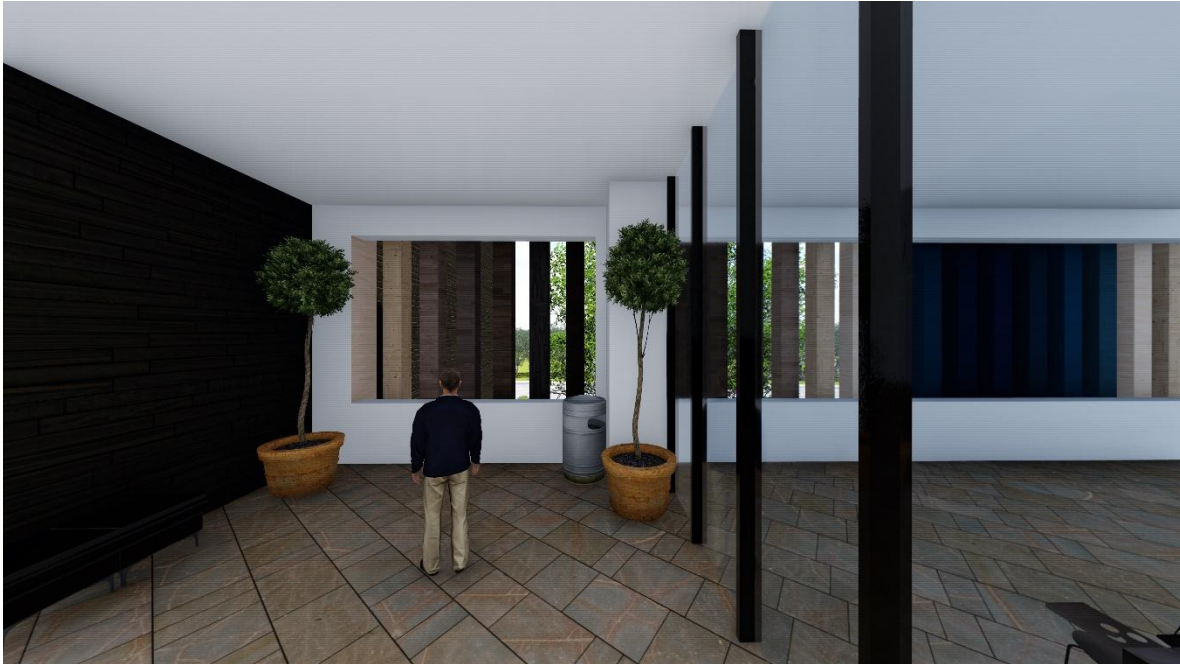
Ilustración 24. Utilización de Parteluces como Mitigación Solar
