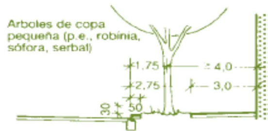
Fuente: Altura y Retiros de copas de Árboles recomendada. Google. 131
