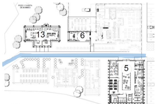
Imagen_018_18032018 Utilización de un pasillo central, uniendo los módulos, cumpliendo con parámetros de la NRD2
