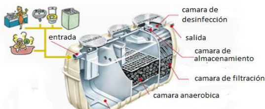
Ilustración 49, planta de tratamiento
