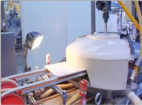
Imágenes 38 y 39. Procesos de la Fabricación de los pisos Cerámicos. Baño de Esmalte y Horneado
