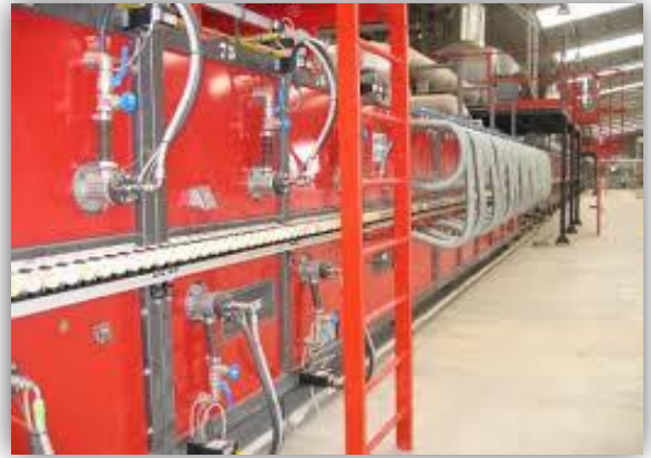
Imágenes 38 y 39. Procesos de la Fabricación de los pisos Cerámicos. Baño de Esmalte y Horneado
