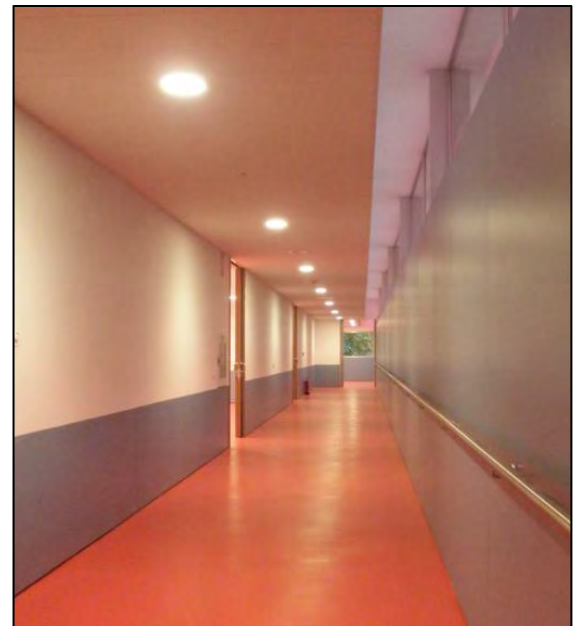
Figura No. 3.1 Pasillo del Centro para Personas con Discapacidad, con pasamanos a los lados, color vivo en el suelo, con buena iluminación y el ancho idóneo para circulación de personas con discapacidad.
