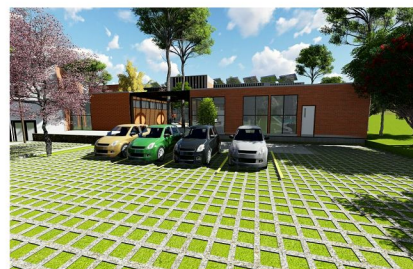
La pavimentación permite la infiltración de agua de lluvia hacia el sub suelo.
