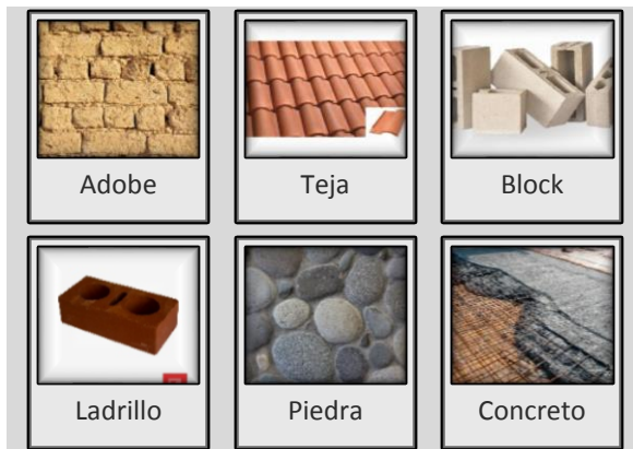
Imagen 128. Materiales locales Fuente: elaboración propia
