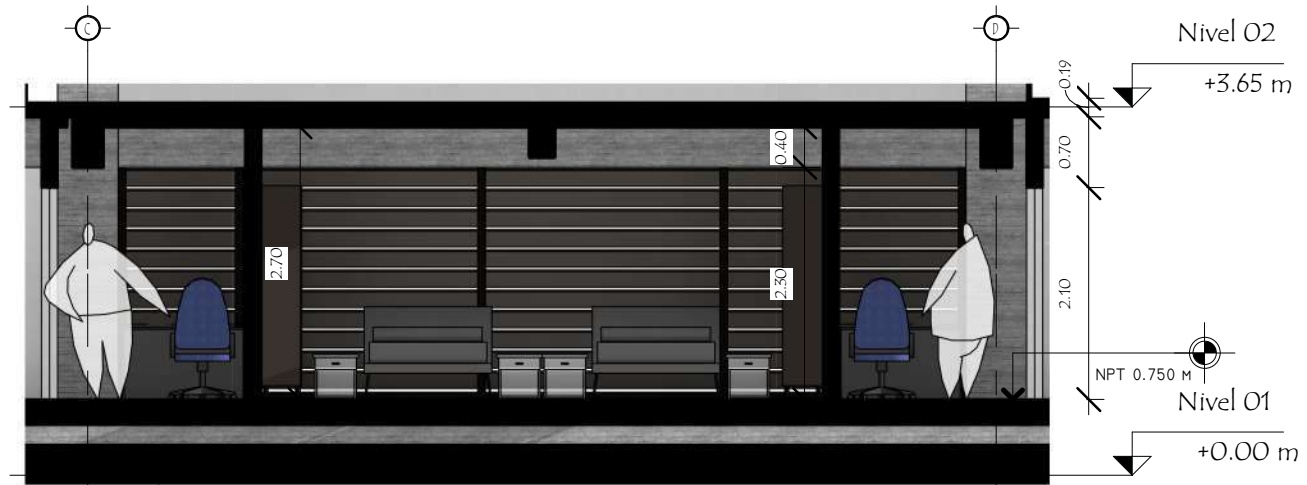
01 - SECCIÓN LONGITUDINAL - GARITA
