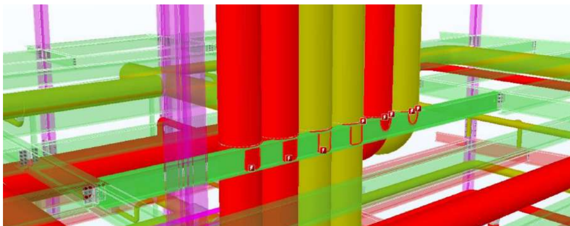
Figura: Colisiones de conductos con viga estructural
