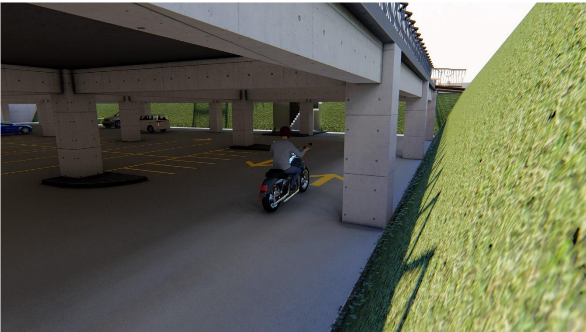
Figura 133. Ingreso de iluminación y ventilación natural al parqueo subterráneo por medio de los taludes, elaboración propia, 2021.
