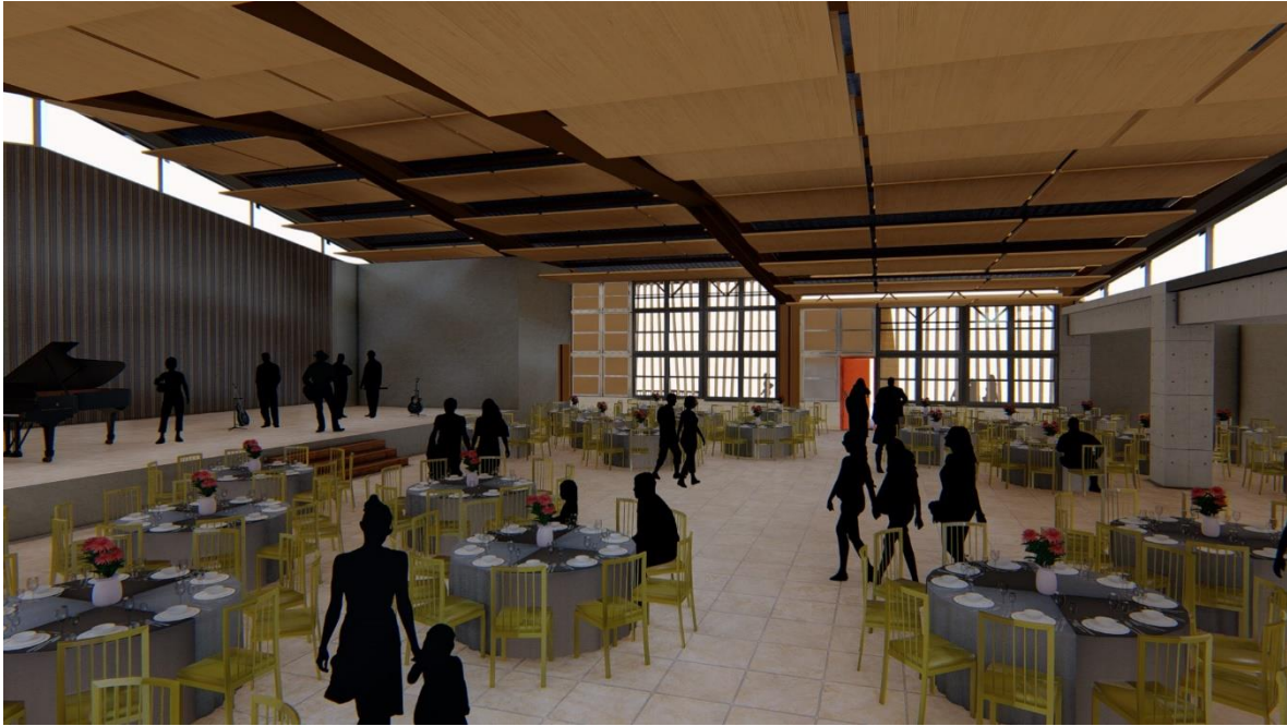
Figura 138. Paneles de madera suspendidos para cielo falso del salón de usos múltiples, elaboración propia, 2021.
