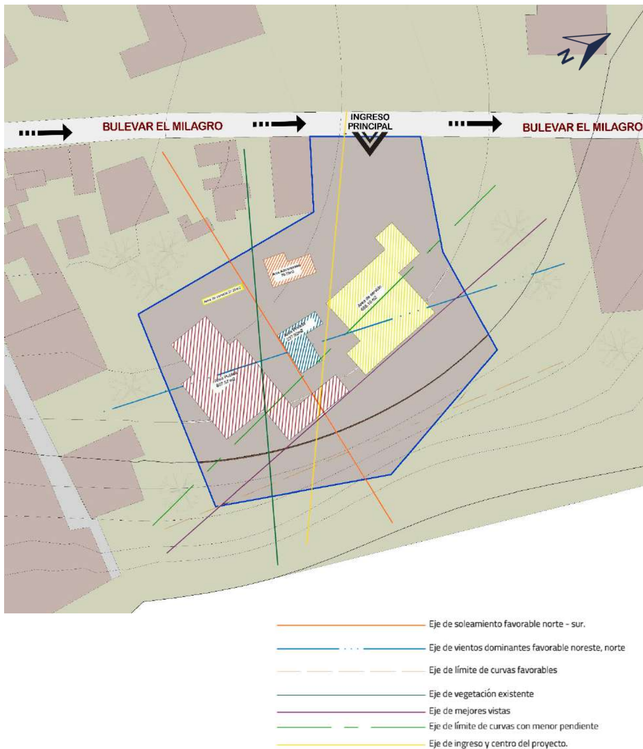
Gráfica 13. Diagrama de ejes de diseño en combinación con el plan maestro, elaboración propia.
