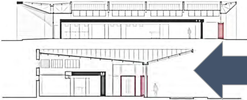
Figura No. 48 Figura No. 49 Secciones. Terminal de buses los lagos -TNG Arquitectos La cubierta es metalica con inclinación dándole movimiento y realizando su doble altura. Fuente http://www.plataformaarquitectura.cl/cl/02-
