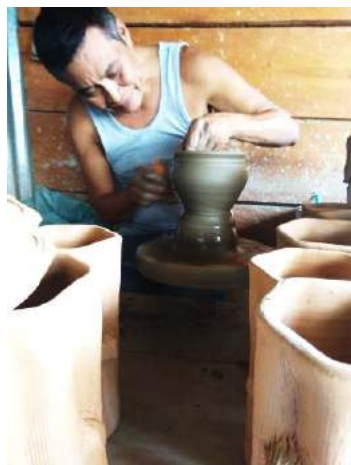
Figura 16 Proceso de elaboración de un jarro en el torno de alfarero, Fotografía: propia (Rabinal B.V. Guatemala 2018)
