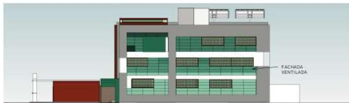
Las fachadas Nor-este y Sur-oeste, poseen un sistema constructivo de cerramiento exterior constituido por una hoja interior, una capa aislante, y una hoja exterior, los cuales corresponden a una fachada ventilada, con ventajas de aislamiento térmico y acústico.
