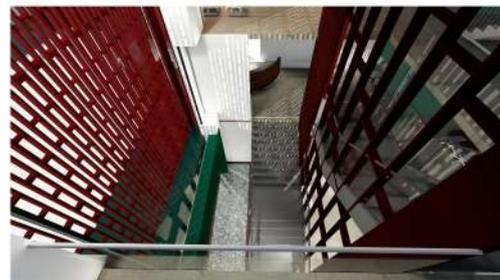
La chimenea de ventilación, posee un espejo de agua en el primer nivel de ambos edificios, lo que permite que controle la temperatura.
