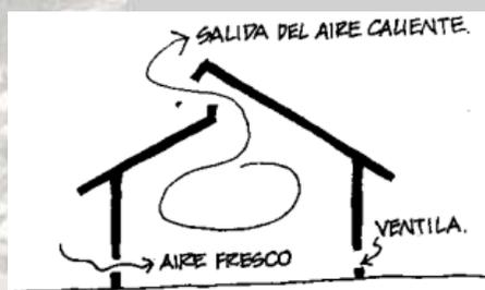
Figura 9. Ventilación con efecto chimenea.
