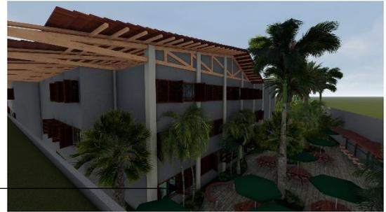
**Modulo:** a aplicación al módulo estructural, se diseñó en base de parámetros de 4x4 metros. Este módulo se repite para crear supermódulos en las plantas y ordenar los ambientes.
