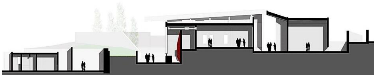
Figura 30 Sección transversal C-C, se observan los cambios de nivel y las dobles alturas jerarquizando las salas.
