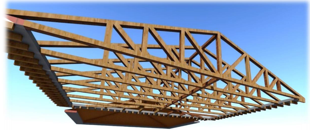
Estructura típica para el armado de tijeras de madera en techo a dos aguas.
