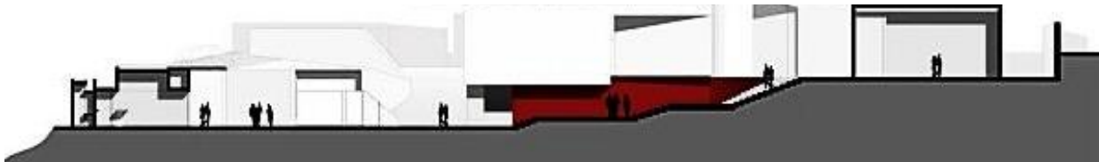
Figura 29 Sección longitudinal B-B, se observa el corte de la plaza principal y el módulo de gradas que comunica la plaza con el área de exposición
