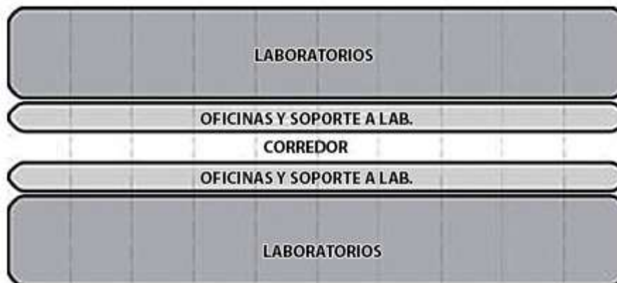
Figura 2.2.30 Diseño de laboratorio de pasillo único con laboratorios y oficinas adyacentes entre sí. Fuente: https://www.wbdg.org/building-types/research-facilities/research-laboratory
