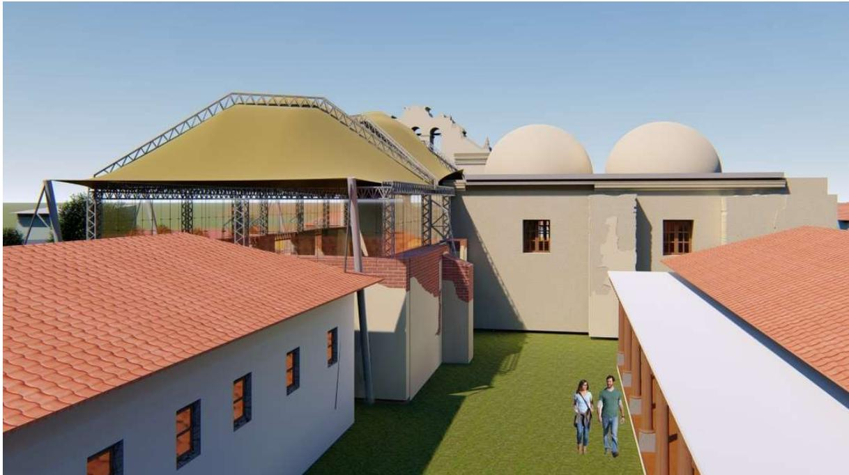
**VISTA INTERIOR DE CAPILLA** (uso propuesto como sala de exhibición. Restauración de muros originales, integración de piso tipo baldosa de barro cocido, mobiliario y cubierta reversible).
