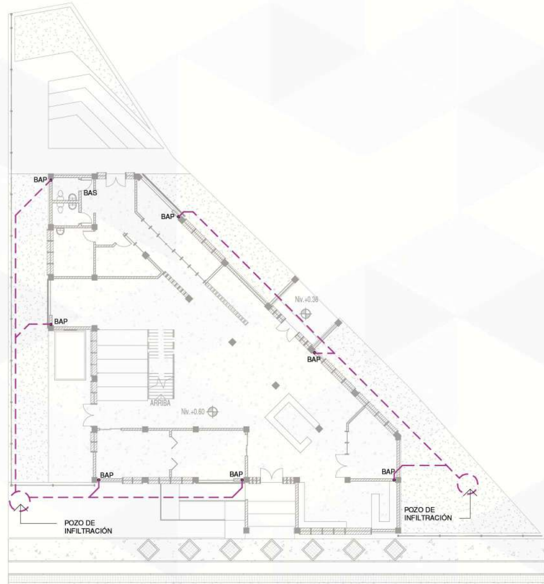
PISO 01 - ESQUEMA DRENAJE PLUVIAL 1 : 300
