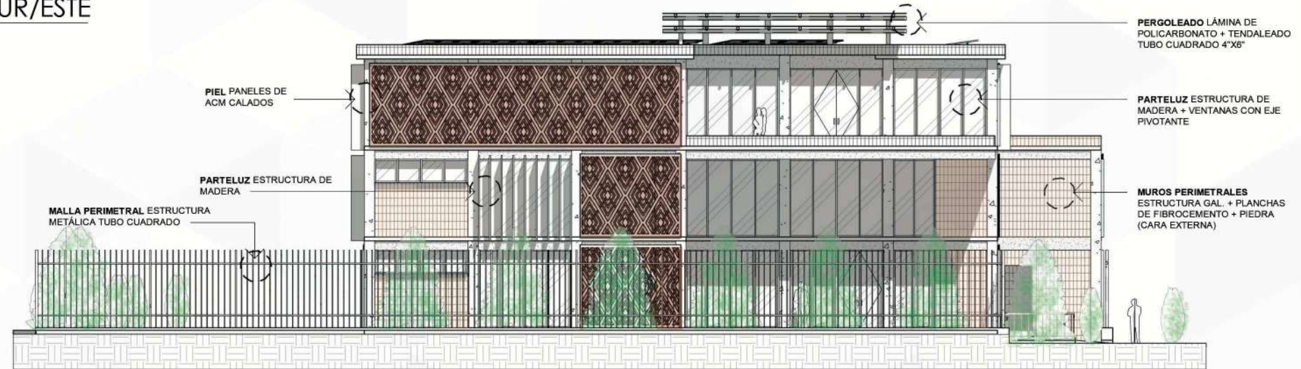
FACHADA LATERAL IZQUIERDA - SUR/OESTE 1 : 200
