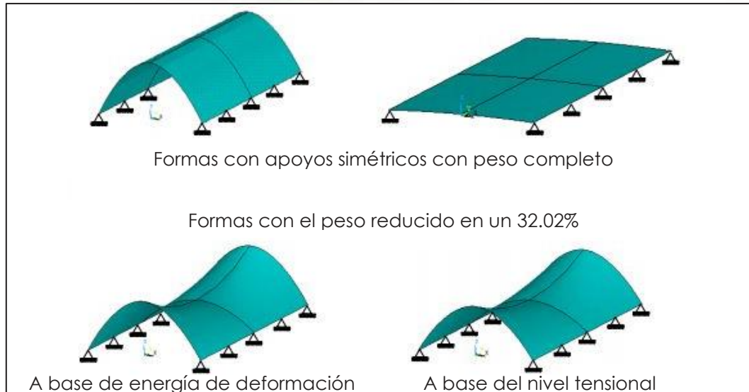
Figura No. 130 Formas según base y peso, Fuente: Elaboración propia a partir de (Antonio Tomas Espin 2007)
