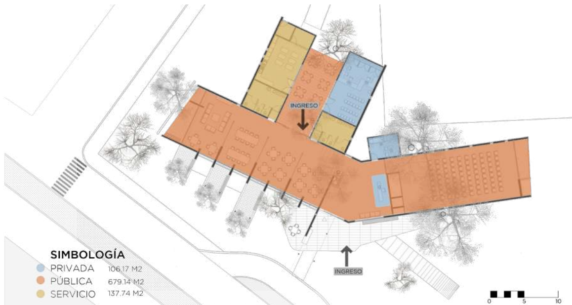
Figura 38: Análisis de la zonificación de la Casa del Abuelo, en base a información de TALLER DIEZ 05. Fuente: Elaboración propia. 2020.
