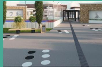
Para las guías/franjas táctiles del proyecto se utilizarán baldosas de concreto.
