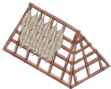
Figura 19. Construcción de cubierta con palma. Fuente: Elaboración propia.
