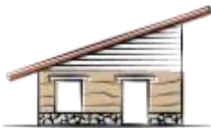
Figura 18. Características constructivas con técnica de tapial. Fuente: Elaboración propia.
