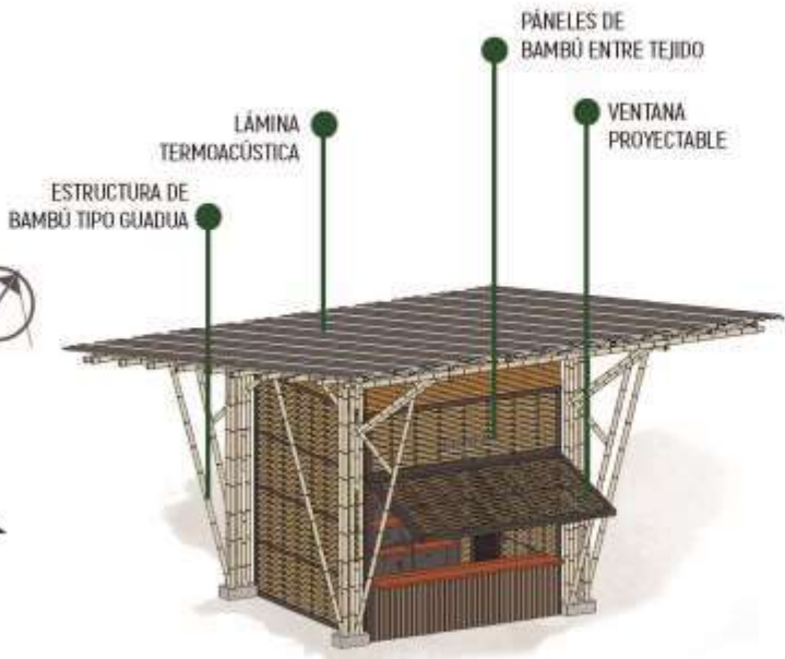
ISOMÉTRICO MÓDULO DE LOCAL ESCALA 1/100
