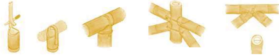
Unión poste y viga
