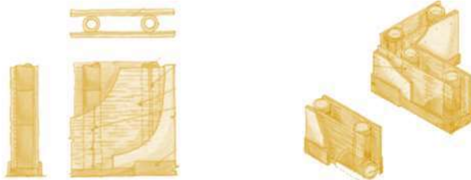
Figura 113. Detalle de muros de bajareque. Fuente: Elaboración propia con base en manual para la construcción sustentable con bambú del Instituto de Tecnología A.C. (INECOL).
