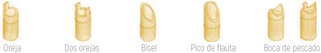
Figura 104. Tipos de cortes de bambú para uniones de estructura. Fuente: Elaboración propia con base en manual para la construcción sustentable con bambú del Instituto de Tecnología A.C. (INECOL).
