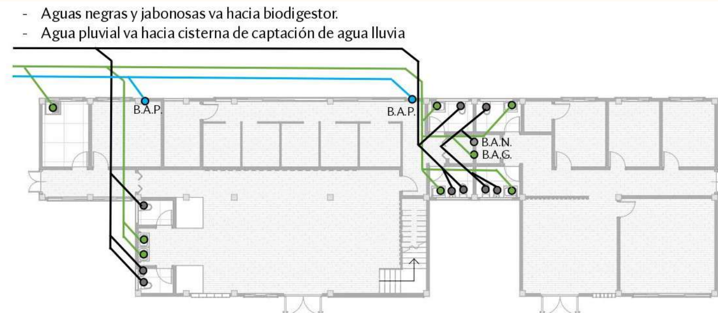
PLANO DE INSTALACIONES SANITARIAS NIVEL 1
